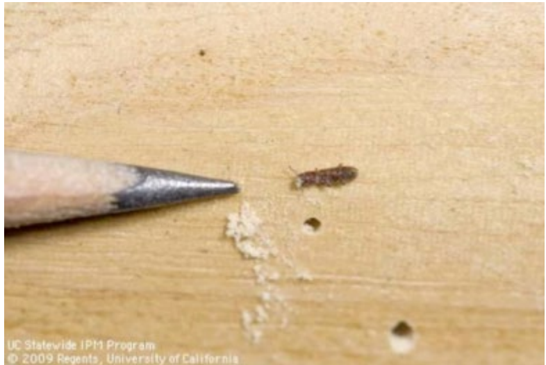
Daños en madera por adultos de Micrapate spp.
